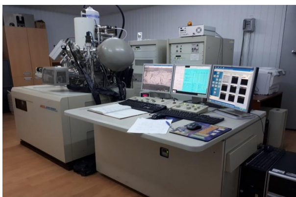
Рис. 2.4. Оже-спектрометр Scanning Auger Microprobe (SAM) JAMP-9500F, оснащений автоемісійною електронною гарматою, що складається зі скануючого електронного мікроскопу (SEM) з камерою для зразків з ультра-високим вакуумом (UHV).
