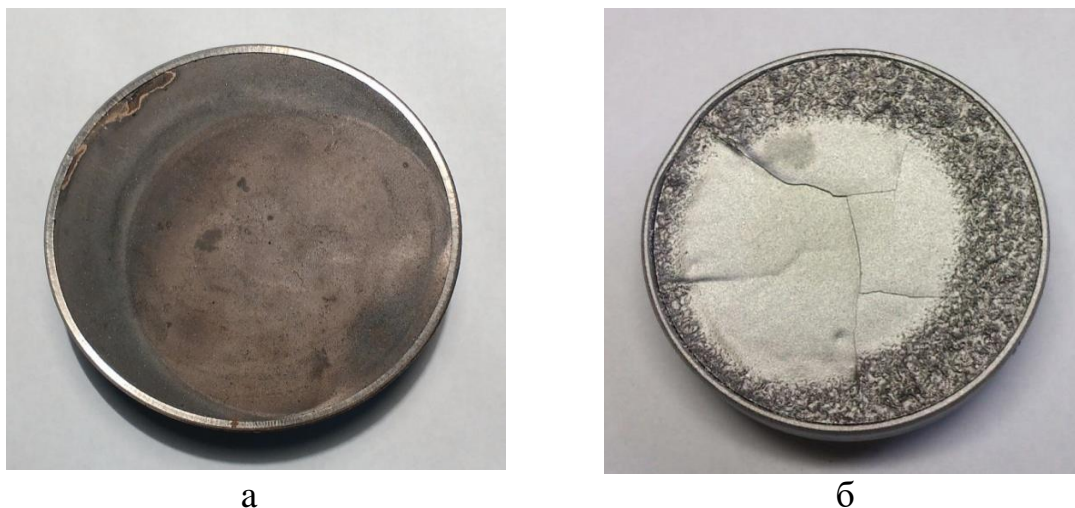
Рис. 3.4. Фото поверхні катоду на основі МАХ фази Ti_2AlC в вихідному стані (а) та після вакуумно-дугового осадження покриттів (б).
