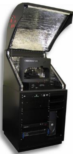
Рис. 2.5. Фотографія установки Nano Indenter G200 для вимірювання модуля Юнга та твердості (а) та схематичне зображення діаграми вдавлювання індентора, отриманої під час наноіндентування (б).
