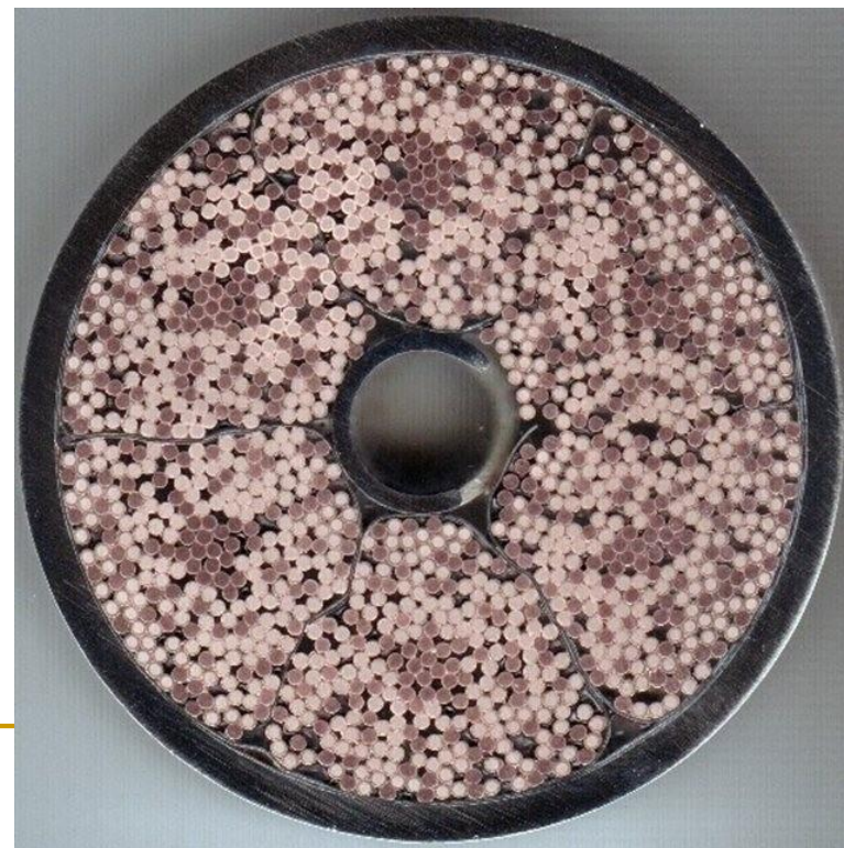
NbTi-стренд для магнитной системы ИТЭР: диаметр проводника 0,73 мм количество Nb-волокон 2346 критическая плотность тока J_c > 2700 \text{ A/мм}^2 (5 Тл, 4,2 К)
